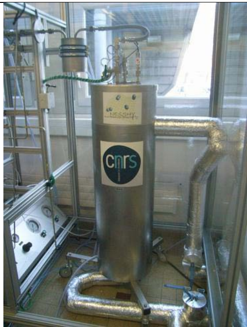
Réservoir de 10 kg de MgH2 (600g H2, 20 kWh) avec circulation périphérique de fluide haute température pour gérer les échanges thermiques.
