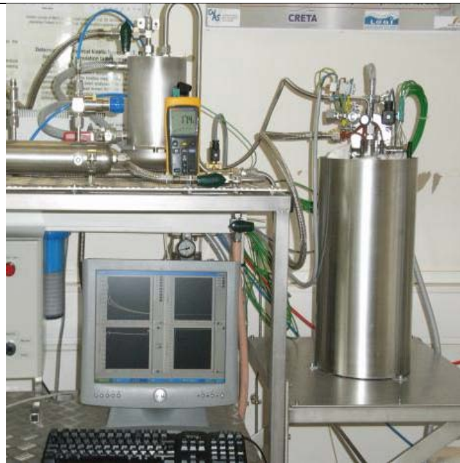
Réservoir de 1.8 kg de MgH2 (100g H2, 3.3 kWh)
