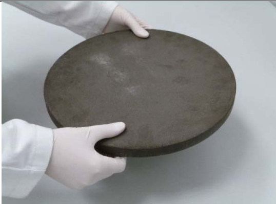
Disque de magnésium de 300 mm tel que mis en production par McPhy
