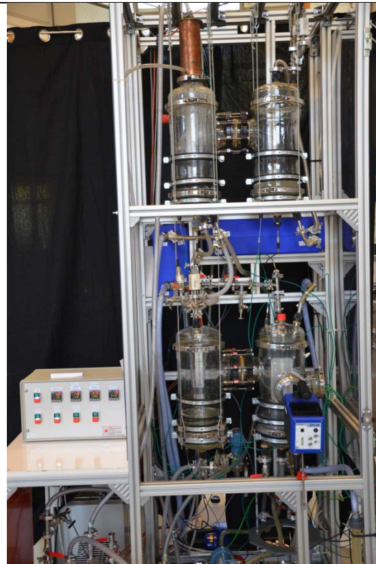
Installation expérimentale dédiée à l'étude de l'absorption en présence de films ruisselants
