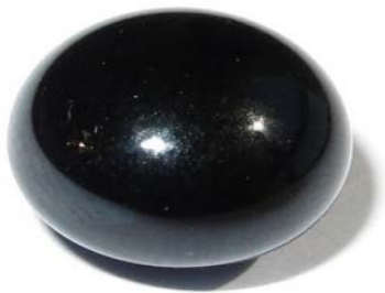
Figure 1 : verre produit par vitrification solaire de cendres volantes de centrales thermiques au charbon
