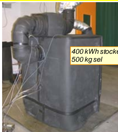
Stockage inter-saisonnier de chaleur solaire (habitat)
