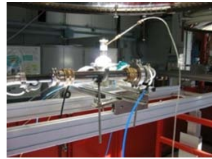
Figure 2 : Prototype de réacteur thermochimique solaire pour la réduction d'oxydes
